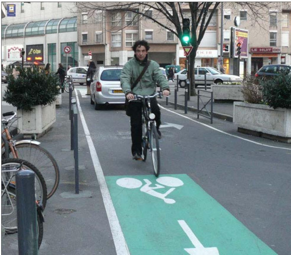
**Figuras 23 y 24. Ejemplos de señalización de una calzada con *double-sens cyclable*.**
